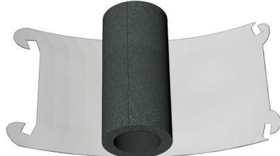
**7** Inserire il materiale fonoassorbente nel corpo di Qtube e spingere fino a quando il fondo del materiale sarà a contatto dell'estremità opposta di Qtube. Si dovrebbe poter osservare il foro al centro del materiale e constatare l'assenza di ostruzioni al flusso d'aria.
