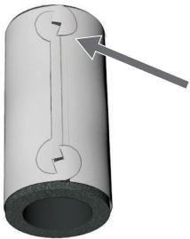
**6** Coloque el nuevo material deflector de espuma sobre el manguito de plástico de revestimiento. Envuelva el material de espuma con el revestimiento de plástico, de manera que se toquen los bordes y las pestañas queden juntas. Cuando las pestañas estén alineadas, deslice una pestaña sobre la otra para que queden cerradas.
