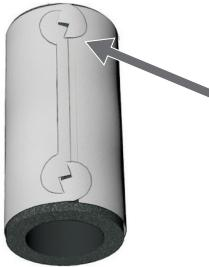
**6** Aseta uusi vaahtokuminen äänieriste muovisuojuksen päälle. Taita suojusta niin, että sen reunat kohtaavat ja hakaset ovat kohdakkain. Liu'uta hakaset vastakaisten hakasten yli siten, että ne kiinnittyvät toisiinsa.
