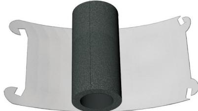
**7** Plaats het opgerolde geluidsisolerende schuim in de behuizing van de Qtube en duw het helemaal naar beneden totdat de onderkant van het schuim het andere uiteinde van de behuizing raakt. U moet door het midden van het opgerolde schuim naar beneden kunnen kijken en te controleren of er niets is dat de luchtstroom hindert.
