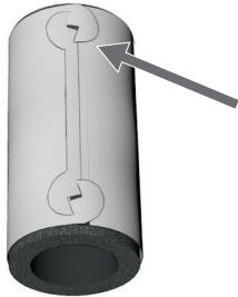
**6** Pegue o material isolante de espuma interno novo e coloque-o em cima do revestimento da manga de plástico. Enrole o material de espuma nos bordos do revestimento da manga de plástico de modo que as presilhas se encontrem e estejam adjacentes uma às outras. Uma vez que as presilhas estejam alinhadas, deslize uma das presilhas dentro da outra de tal forma que se encaixem.
