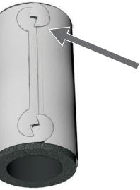
**6** Prenez le matériau intérieur de chicanage acoustique en mousse et placez-le en haut de la garniture du manchon en plastique. Roulez le matériau en mousse, afin que les bords de la garniture du manchon en plastique se touchent et que les languettes se trouvent les unes à côté des autres. Une fois que les languettes sont alignées, faites glisser l'une des languettes par-dessus une autre, afin qu'elles se verrouillent.
