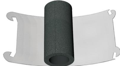
**7** Вставьте свернутый внутренний звукопоглощающий пеноматериал в корпус устройства Qtube и нажимая на него, установите на место так, чтобы материал уперся в противоположный конец корпуса устройства. Если после установки посмотреть вниз через центр материала, вы должны увидеть, что центр свободен и ничего не препятствует прохождению через него потока воздуха.
