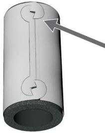
**6** Positionieren Sie den neuen Innenschaumstoff (Dämpfungsmaterial) oben auf der Auskleidung der Kunststoffhülse. Rollen Sie das Schaumstoffmaterial so, dass die Auskleidungskanten der Kunststoffhülse aufeinandertreffen und sich die Laschen nebeneinander befinden. Wenn die Laschen ausgerichtet sind, bewegen Sie eine der Laschen an der anderen vorbei, um eine Verriegelung herzustellen.
