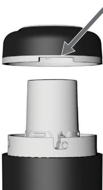
**2** Возьмитесь за верхнюю часть наконечника и слегка поверните его по часовой стрелке так, чтобы штифты вышли в вертикальные пазы на корпусе устройства Qtube.
