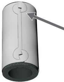
**6** Umieścić nowy piankowy materiał tłumiący na plastikowej tulei. Zwinąć piankowy materiał w taki sposób, aby krawędzie plastikowej tulei zetknęły się, a wypustki znalazły się obok siebie. Po wyrównaniu wypustek nasunąć jedną z nich na drugą, tak aby się zaczepiły.
