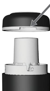
**2** Afferrare il Tappo terminale e ruotare leggermente in senso orario fino a quando il perno si allinea con le fessure verticali sul corpo di Qtube.
