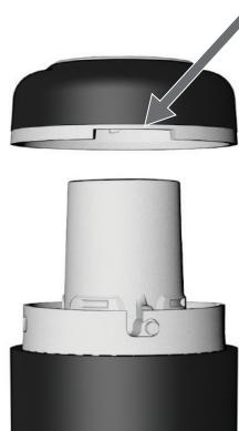
**2** Halten Sie die Endkappe am oberen Rand und drehen Sie sie leicht im Uhrzeigersinn, bis die Stifte mit den vertikalen Schlitzen im Qtube-Gehäuse ausgerichtet sind.
