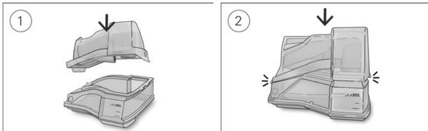
1. Führen Sie eine Seite des Deckels in die Scharnieröffnung am Unterteil ein.
