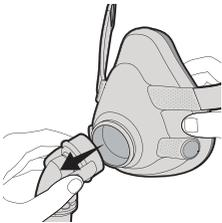
**1** Um das Kniestück von der Maske zu entfernen, drücken Sie die beiden seitlichen Knöpfe und ziehen Sie das Kniestück von der Maske ab.
