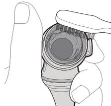
**3** Schütteln Sie das Kniestück für mindestens eine Minute kräftig im Wasser und reinigen Sie es per Hand mit einer weichen Bürste. Achten Sie dabei besonders auf alle Verbindungsteile, Ausatemöffnungen und Ventile.
