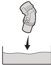
**2** Weichen Sie das Kniestück mit einem milden Flüssigreiniger für etwa 10 Minuten in warmem Wasser (ca. 30°C) ein.
